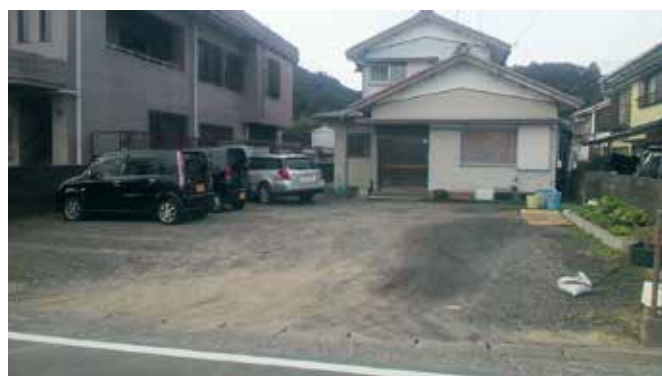
厚さ約20cmの汚泥が堆積（汚泥は水を含み粘土質のものであった）
