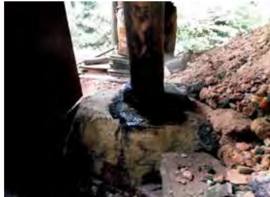
こうしてゆっくりと燃やしていくと3日～4日でカザが無くなります。一度焼けた状態です。この状態でヒアナと空気穴の全てを塞いで窯の中で火を消してしまったものを黒炭と言います。紀州備長炭などの白炭は火を消すのではなく、アラシ又はネラシといって36時間～48時間かけて空気穴を大きくしていき窯の中の温度を1200℃まで上げた状態で炭を窯から出して火を消す工程を行います。
